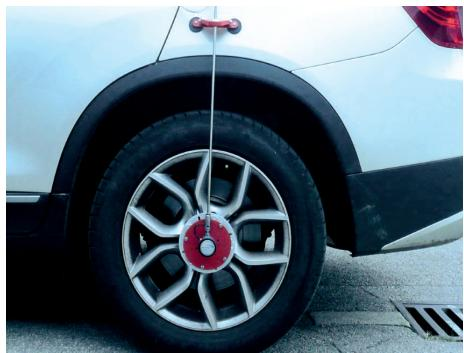
Schleifringüberträger werden beim Einsatz der Übertragung unterschiedlicher Messsignale (z.B. Temperatur) von rotierenden Fahrzeugräder eingesetzt.
