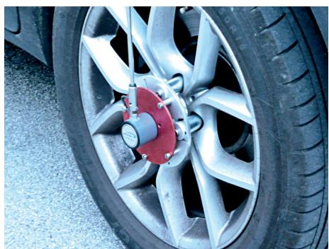
Eine schnelle Adaption auf die unterschiedlichen Felgen und Radmuttern wird mit unseren Spannzangen erreicht.
